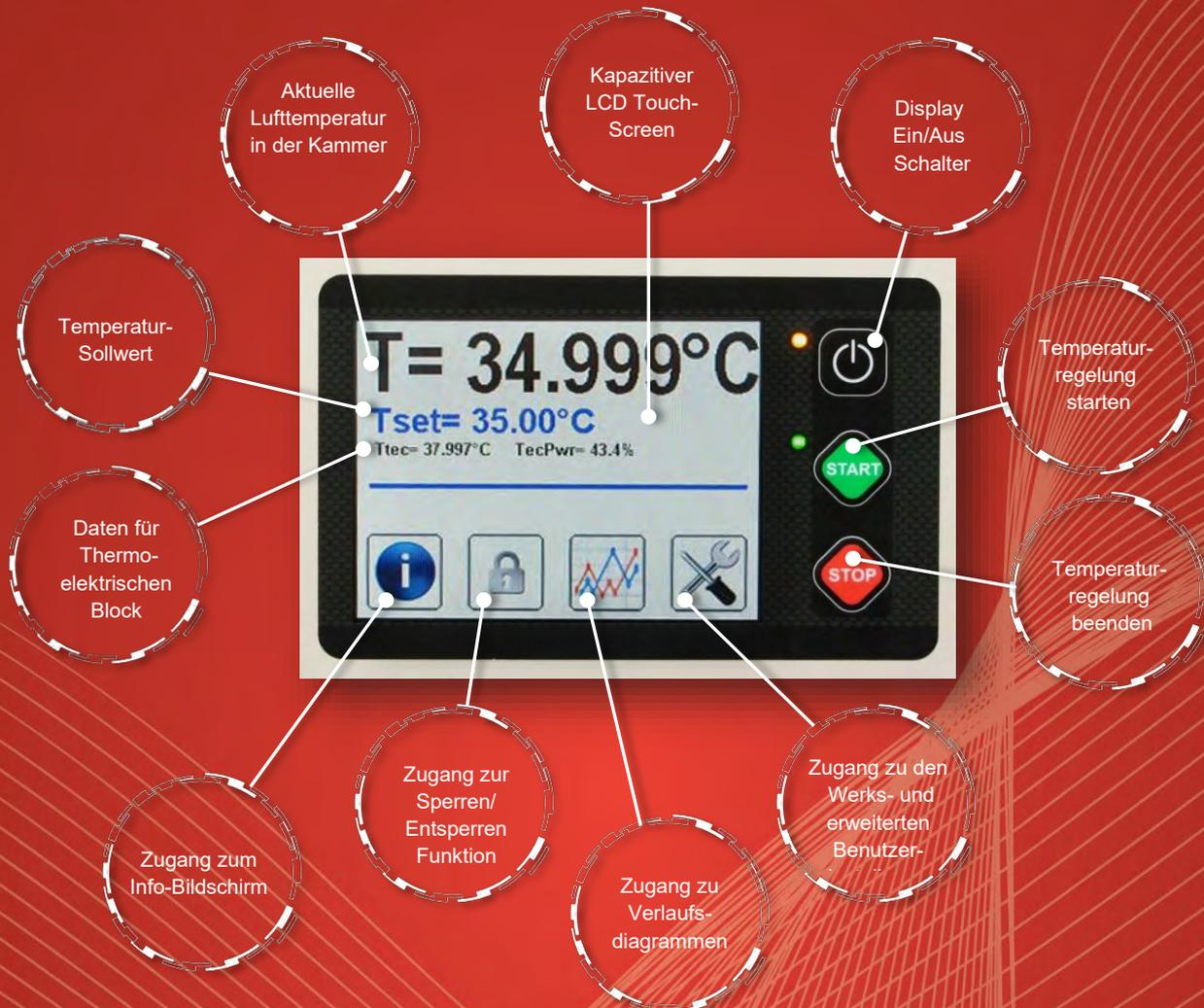
**Temperaturstabilität in der Kammer:  $\pm 0.003$  bei  $23\text{ }^{\circ}\text{C}$**
